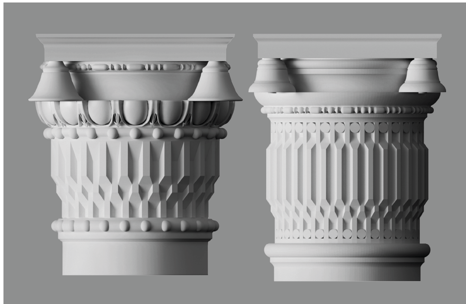
Figura 11. Comparativa de la versión preliminar del orden Delhi (izq.), reconstruida en 3D a partir de un boceto de 1914, y la versión definitiva utilizada en la Casa del Virrey (der.). Elaboración propia
