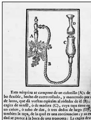
Esta m quina se compone de un ca utillo (A); de tubo flexible, hecho de cuero rollado, y mantenido por un lat n, que da vueltas espirales al rededor de  l (B); de cagita de muelle,   de madera (C), cuya tapa tiene en su interior un ca on,   tubo de dos,   tres dedos de largo (D), y tambi n la tapa, de la qual es una continuaci n; y su estada se parece   la boca de una trompeta: La cagita deve
