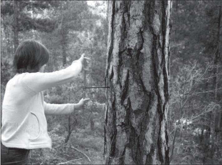
*Figura 1. Extracción de muestras de Pinus nigra, Arnold con barrena Pressler de 5 mm.*
