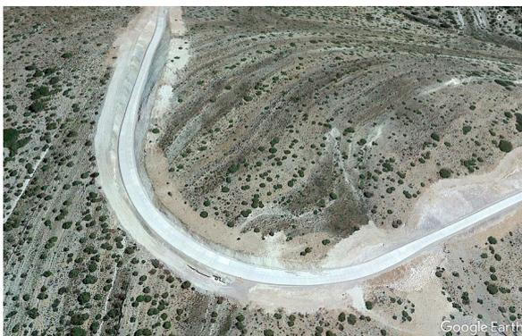
**Figura 1.** Arriba: Imagen oblicua de Google Earth que muestra el estado en construcción del parque eólico “Allueva”, en la provincia de Teruel. Abajo: Detalle de los desmontes y terraplenes en una de curvas del vial de acceso principal.
